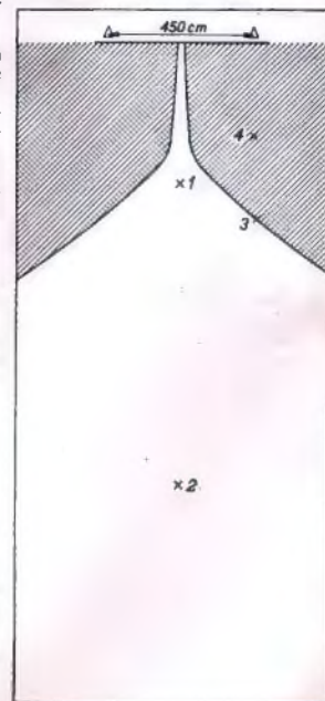
Bild 3. Auf den Plätzen in den schraffierten Gebieten nimmt man eine maximale Verfrüherung des „Schallbildes“ über höchstens die halbe Leinwand-Breite wahr; der plastische Effekt bleibt ungenügend.
