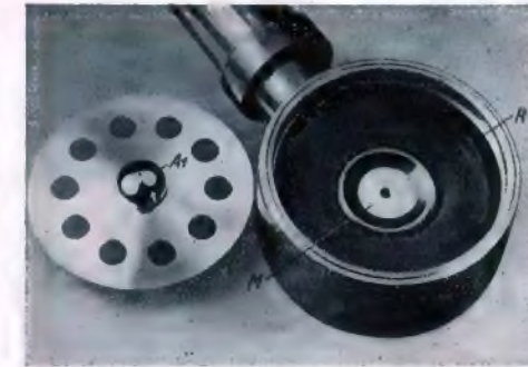
Bild 14. Elektrostatistische Hochspannungslinse des AEG-Übermikroskops. A 1 = Außenelektrode, M = Mittelelektrode, R = Isolator.
