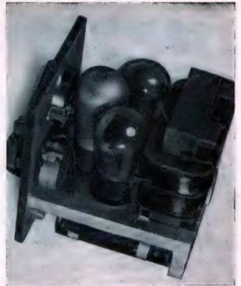
Bild 5. Innenansicht des Röhrenvoltmeters.
