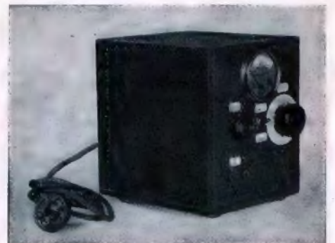
Bild 6. Das Röhrenvoltmeter in seinem Gehäuse.
